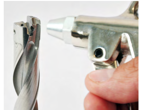
3. Pulire la sede dell'inserto con aria compressa.
