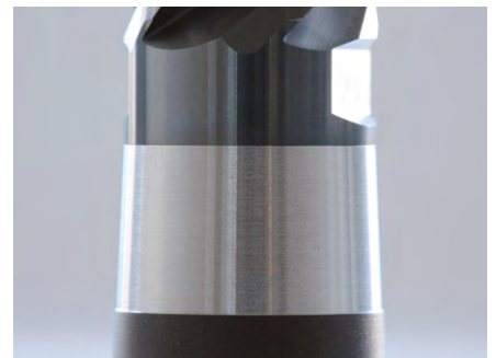
3. Enroskar manualmente el cabezal de fresado intercambiable en sentido horario en el portaherramientas para cabezal intercambiable. Seguidamente, sujetar el portaherramientas para cabezal intercambiable junto con la herramienta en el soporte de la máquina.
