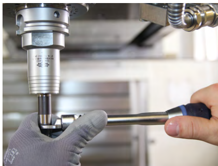
5. Nota: Colocar la mano libre en el cabezal de fresado intercambiable para poder realizar una adaptación precisa. De este modo, puede ajustarse con mayor precisión el par de apriete.
