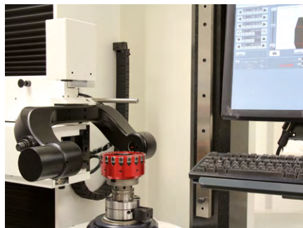
5. Ajustar ópticamente con el dispositivo de ajuste un cartucho de fresar -0,01\text{ mm} antes de la medida de ajuste EM. Captar a tal efecto el filo de corte con el instrumento de medición óptico y girar el tornillo diferencial con una llave Allen en sentido de las agujas del reloj hasta alcanzar \text{EM} = -0,01\text{ mm} . Para realizar un ajuste puramente óptico, repetir este procedimiento en los cartuchos de fresar restantes (seguidamente continuar con el paso 7).
