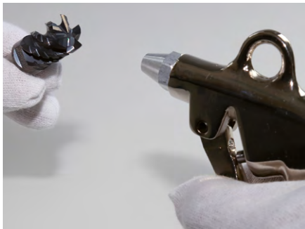
1. Limpiar el cabezal de fresado intercambiable en el cono, la rosca y la cara plana usando aire comprimido y un paño.
