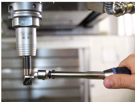
4. Colocar la llave dinamoétrica lo más horizontal posible en el cabezal de fresado intercambiable, sin inclinar el plano de la llave al hacerlo.
