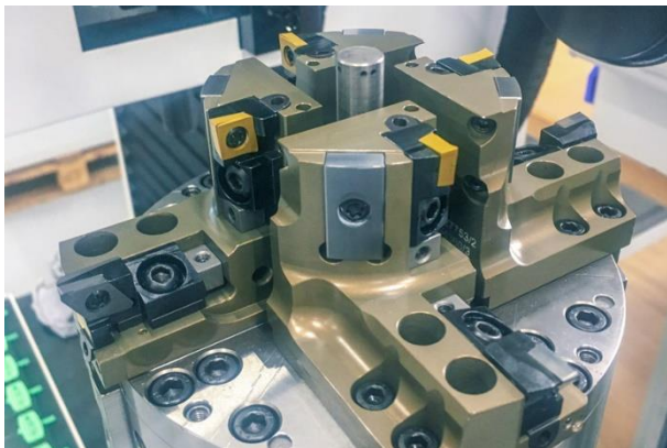
Hochpräzise Einstellung der Schneiden mit dem UNISET-V von MAPAL. ©MAPAL
