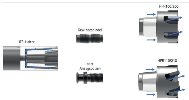
Abb. 8: Kühlmittelführung ohne zentralen Durchgang
