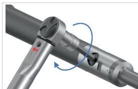
Abb. 16: Spannbolzen mit Anzugsdrehmoment anziehen
