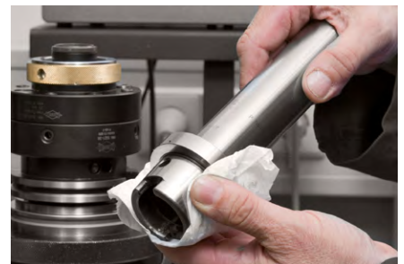
3. Kegel und Planfläche von Prüfdorn beziehungsweise Werkzeug sorgfältig reinigen. Prüfdorn beziehungsweise Werkzeug einsetzen.
