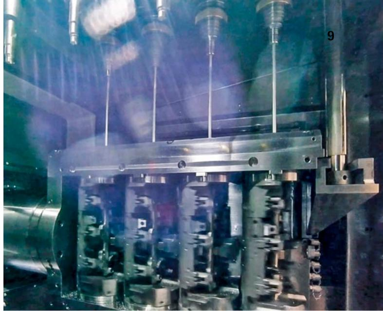
Vierfach-Bearbeitung von Kraftstoff-Verteilerleisten mit Tiefbohrern. Die Besonderheit der Lösung sind die gegenläufig rotierenden Spannvorrichtungen, um den Verlauf des Bohrers zu minimieren. (Foto: ELHA)
