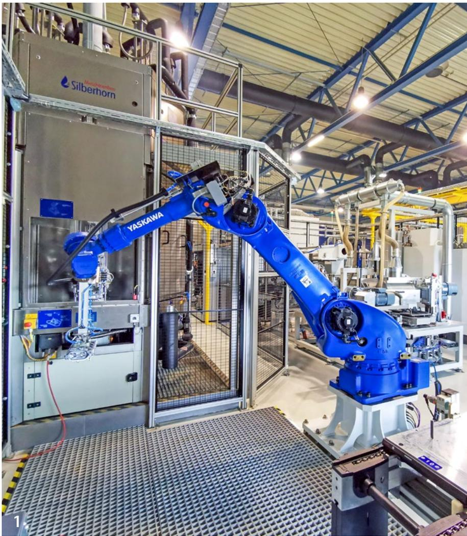
1 Vollautomatisierte Fertigungslinie für die Bearbeitung von Aluminium-Druckgussteilen für die Automobilindustrie.
