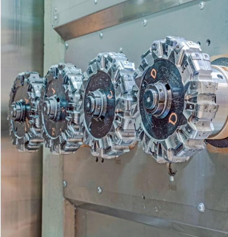
Vierfach-Einsatz von Scheibenfräsern für Querlenker. Die massiven Schnittstellen sind ein Hinweis auf die hohen erforderlichen Antriebsleistungen. (Foto: ELHA)
