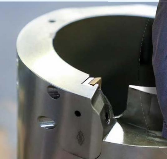
*Das EasyAdjust-System von MAPAL reduziert die Einstellzeiten der hochpräzisen Reibwerkzeuge. Die Verjüngung ist in eine Kassette integriert, ein manuelles Einstellen entfällt.*
