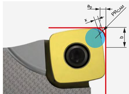
Beim Einsatz einer HFC-Wendeschneidplatte ist der Programmerradius  $PR_{CAM}$  zu beachten.
