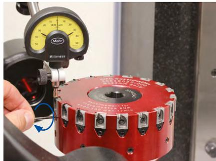
8. Mit dem Einstellgerät optisch den Fräseinsatz mit der höchststehenden Schneidkante ermitteln und die Messuhr auf Null setzen. Alle Fräseinsätze per Messuhr zur höchststehenden Schneidkante einstellen: Hierzu die Gewindespindel mit einem Innensechskantschlüssel im Uhrzeigersinn drehen, bis das Nullmaß erreicht ist (Toleranz  $\pm 2 \mu\text{m}$ ).
