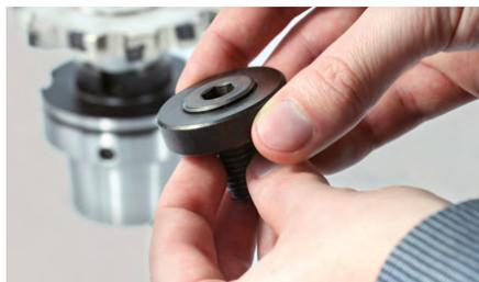
6. Den Gewindebolzen so lange drehen, bis er zum Gewinding einen Überstand von 1-2 mm hat.
