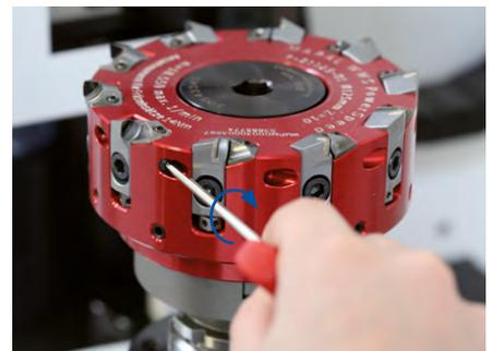
6. **Optional:** Die Sicherungsschraube bis zum Anschlag mit einem Innensechskantschlüssel im Uhrzeigersinn eindrehen und anschließend eine halbe Umdrehung zurückdrehen.
