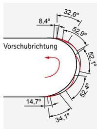
Umschlingung in Abhängigkeit der Bahnposition – Optimierte Bahnkurve
