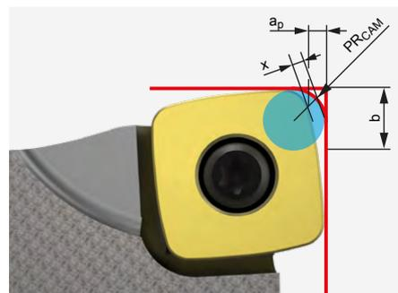
Beim Einsatz einer HFC-Wendeschneidplatte ist der Programmerradius PR<sub>CAM</sub> zu beachten.
