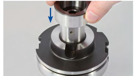
3. Den ersten Distanzring auf den Aufsteckfräserdorn aufsetzen.
