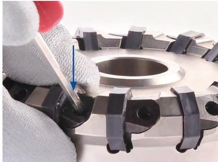
3. Die Wendeschneidplatte nach unten drücken und darauf achten, dass die Wendeschneidplatte an beiden Anlageflächen am Umfang anliegt.
