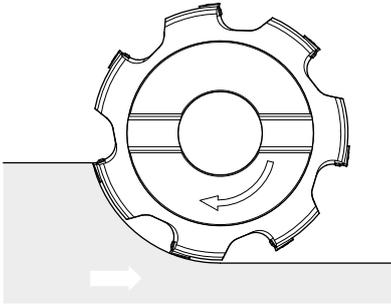
Beim Eintritt der Schneide in den spanabtragenden Schnitt hat diese zerspannungstechnisch die ungünstige Spannungsdicke Null und tritt mit maximaler Spannungsdicke  $h_{\max}$  aus dem Werkstoff aus. Dabei entsteht beim Gegenlaufräsen Reibung. Diese führt zu Spanverschweißungen und zur Wärmeübertragung in die Schneidplatte und in das Werkstück.
