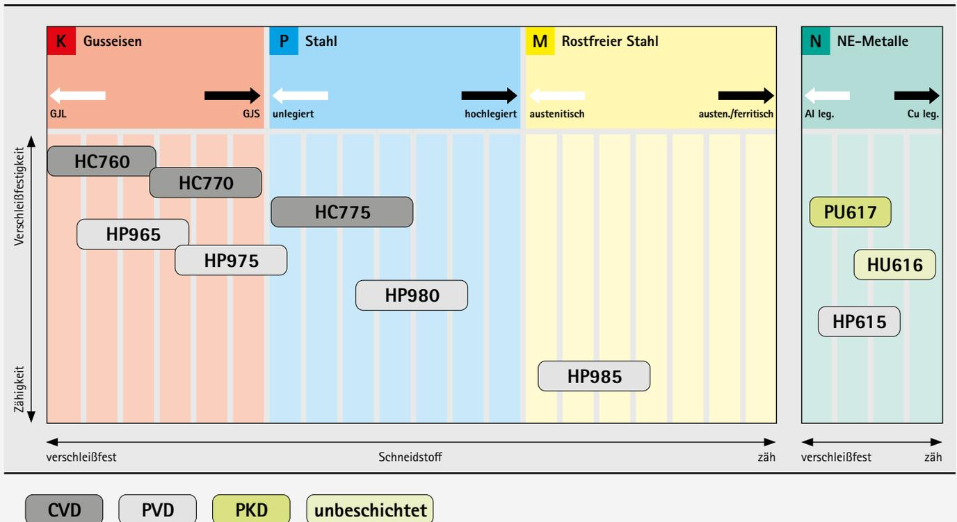
Schneidstoffübersicht | Hochvorschub- und Kopierfräser aus dem Werkzeug- und Formenbau
