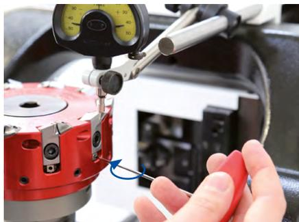
10. Entweder optisch oder taktil den Fräseinsatz mit der höchststehenden Schneidkante ermitteln und die Messuhr auf Null setzen. Alle Fräseinsätze nach Messuhr zur höchststehenden Schneidkante einstellen: Hierzu die Stellschraube mit einem Innensechskantschlüssel im Uhrzeigersinn drehen, bis das Nullmaß erreicht ist (Toleranz  $\pm 2$   $\mu$ m).
