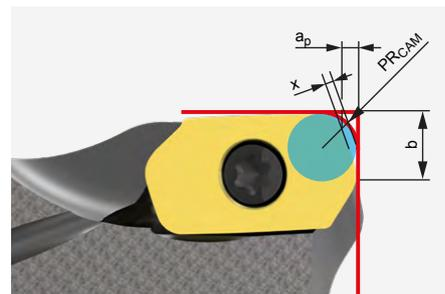
Beim Einsatz einer HFC-Wendeschneidplatte ist der Programmerradius  $PR_{CAM}$  zu beachten.
