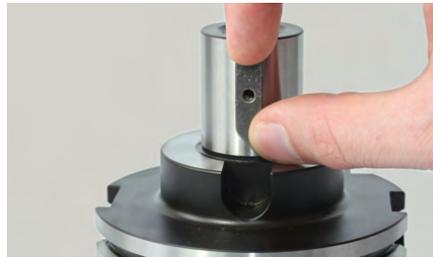
2. Die Passfeder am Aufsteckfräserdorn einsetzen.
