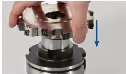
5. Das Werkzeug auf den Aufsteckfräserdorn plan aufsetzen.
