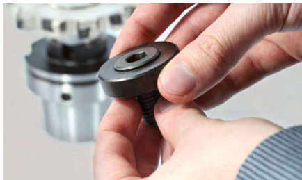
6. Girar o pino rosqueado até ele atingir a medida excedente de 1-2 mm em relação ao anel rosqueado.
