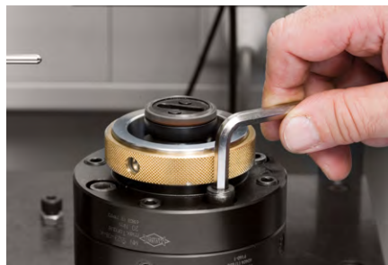
2. 装入前置法兰盘放上紧固螺钉。
