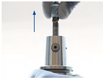
2. 从侧固定刀柄的装夹孔中取出刀具。
