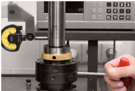
4. 将千分表放在径向跳动精度控制点的位置。MAPAL 公司刀具也可以向 HSK 轴环对准。记录最低测量点并将千分表设置为“零”。进行径向校准。
