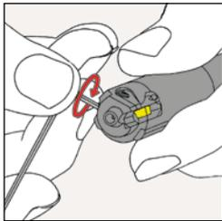
1. Den vorderen und hinteren Gewindestift eine halbe Umdrehung nach links drehen.
