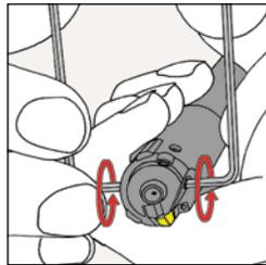
2. **Hinweis:** Zum Öffnen müssen zwei Schlüssel verwendet werden. Zum Lösen der Spannplatte und der Kasette die TORX®-Schraube bzw. die Gewindespindel von oben nach links und von unten nach rechts drehen.
