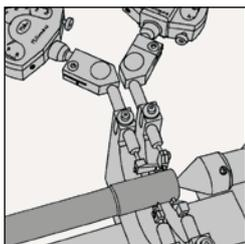
7. Das MAPAL MASTERSET mit Einstellhorn (muss separat bestellt werden) eichen. Der Einstellhorn hat das Kleinmaß der Bohrung.
