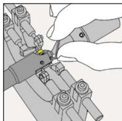
8. Das vordere und hintere Einstellmaß in wechselnden Intervallen mit den Gewindestiften einstellen. Die Verjüngung nach hinten beträgt ca. 0,005 bis 0,010 mm.
