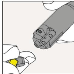
3. Die Wendeplatte und die Kasette herausnehmen. Die Wendeplatte, die Kasette und den Wendeplattensitz reinigen (keine Druckluft verwenden, Justierkeile beachten). Die Wendeplatte um 60° weiterdrehen bzw. die neue Wendeplatte in die Kasette einsetzen. Die Kasette wieder einbauen.
