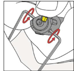
4. **Hinweis:** Zum Anziehen müssen zwei Schlüssel verwendet werden. Die Wendeplatte und die Kasette gegen den hinteren Anschlag und den Justierkeil drücken. Die TORX®-Schraube bzw. die Gewindespindel von oben nach rechts und von unten nach links drehen und anziehen.
