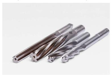
Aufbohr- und Reibwerkzeuge für Durchgangsbohrungen mit speziellen Schneiden und Führungselementen zur zuverlässigen Herstellung von präzisen Bohrungen mit hoher Oberflächengüte und exakter Rundlaufgenauigkeit. ©MAPAL
