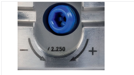
Abb. 6: Beschriftung zur Prüfung der Spannkraft
