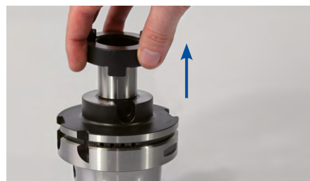
1. Zdjąć pierścień prowadzący z trzpienia frezarskiego nasadzanego.
