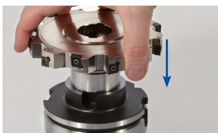
5. Umieścić narzędzie czołowo na trzpieniu frezarskim nasadzonym.
