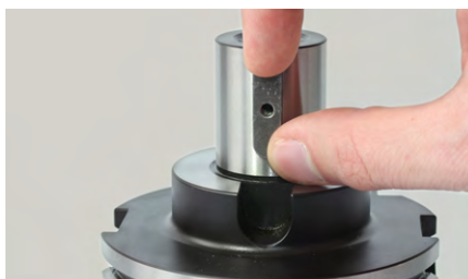
2. Włożyć wpust piórowy na trzpień frezarski nasadzany.
