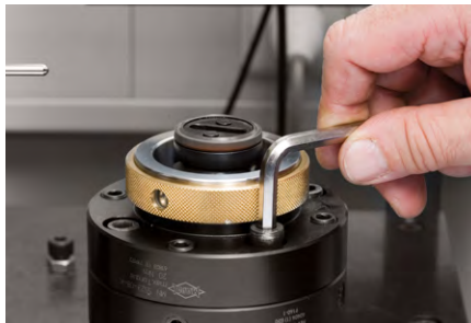
2. 装入前置法兰盘放上紧固螺钉。
