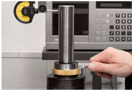
5. 要进行角度校准，请将千分表放在上部检查点或距离链接尺寸约 100 mm 处。使用校准螺钉校准角度。操作后不要松开校准螺钉。
