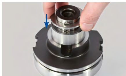
4. Nałożyć drugi pierścień dystansowy na pierwszy pierścień dystansowy i trzpień frezarski nasadzany.
