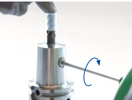
3. 将刀具从上方压紧。同时，将夹紧螺钉以顺时针方向直到止挡位置旋转。 ➔ 该夹紧螺钉靠紧在刀具的HB-面上。 4. 将夹紧螺钉向后旋转半圈。
