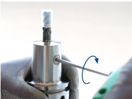
5. 将扭矩扳手设置到所指定的拧紧扭矩（参见“夹紧螺钉的拧紧扭矩”表格）。 6. 使用扭矩扳手将夹紧螺钉拧紧到止挡位置。
