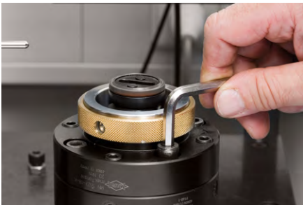
2. 装入前置法兰盘放上紧固螺钉。
