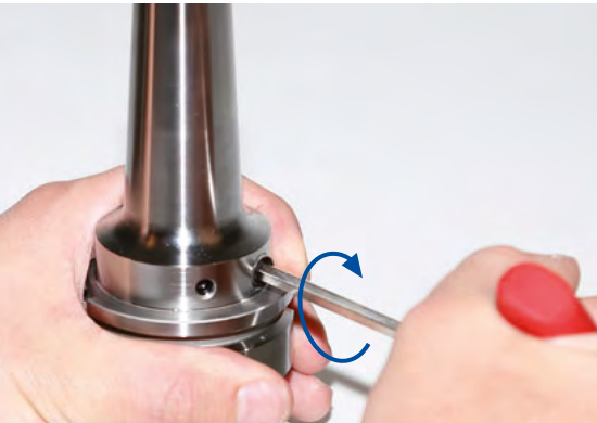
插图 2： 拧紧夹紧螺钉并注意最小转数。
