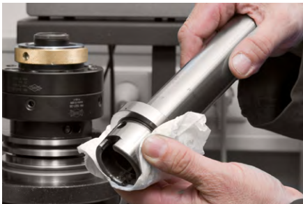
3. 仔细清洁测试样棒或刀具的锥体和平面。装入测试样棒或刀具。
