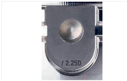
Abb. 6: Beschriftung zur Prüfung der Spannkraft
