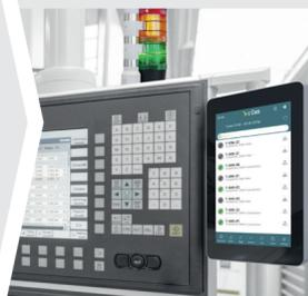
Numérisation rapide et aisée : la c-Connect Box transmet numériquement les données de mesure du poste de réglage à la machine-outil. En outre, elle surveille l'état de la machine.
