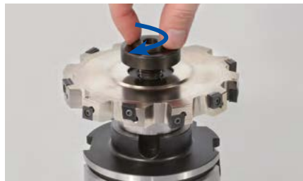
7. Die Fräseranzugsschraube auf den Aufsteckfräserdorn leicht im Uhrzeigersinn eindrehen.
