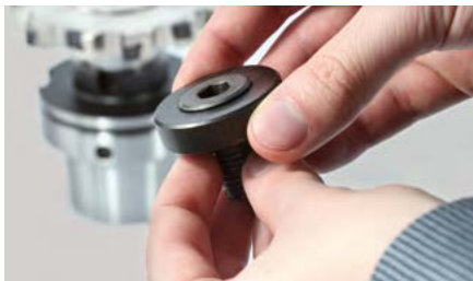
6. Den Gewindebolzen so lange drehen, bis er zum Gewinding einen Überstand von 1-2 mm hat.
