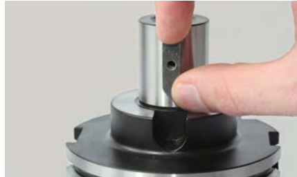
2. Die Passfeder am Aufsteckfräserdorn einsetzen.
