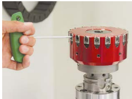
2. Die Spannschraube des Fräseinsatzes lösen und nach oben aus der Schwalbenschwanzführung entnehmen.
