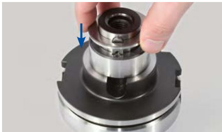
4. Den zweiten Distanzring auf den ersten Distanzring und den Aufsteckfräserdorn aufsetzen.
