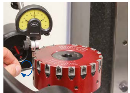
6. Die Messuhr auf dem eingestellten Fräseinsatz positionieren und auf Null setzen. Die Fräseinsätze per Messuhr 0,01 mm vor EM einstellen: Hierzu Gewindespindel mit Innensechskantschlüssel im Uhrzeigersinn drehen bis Nullmaß erreicht ist.
