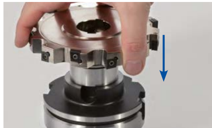
5. Das Werkzeug auf den Aufsteckfräserdorn plan aufsetzen.
