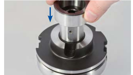
3. Den ersten Distanzring auf den Aufsteckfräserdorn aufsetzen.
