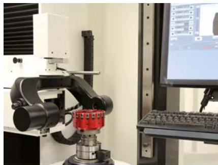
5. Mit dem Einstellgerät optisch einen Fräseinsatz -0,01 mm vor Einstellmaß (EM) einstellen. Hierzu mit der optischen Messeinrichtung die Schneidkante erfassen und die Gewindespindel mit einem Innensechskantschlüssel im Uhrzeigersinn drehen bis \text{EM} = -0,01 mm erreicht ist. Für eine rein optische Einstellung dieses Vorgehen für die restlichen Fräseinsätze wiederholen (anschließend weiter mit Schritt 7).
