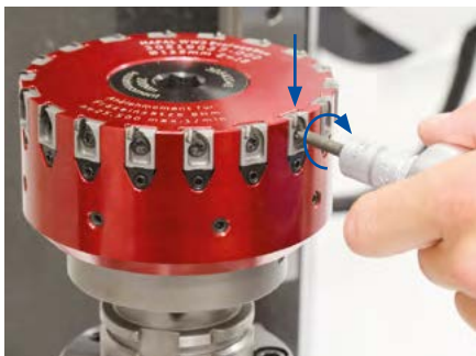
4. Den Fräseinsatz während des Anziehens leicht andrücken, sodass der Justierkeil anliegt. Die Spannschraube** des Fräseinsatzes einsetzen und mit 1-2 Nm im Uhrzeigersinn anziehen.
