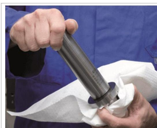
Abb. 9: Werkzeugschaft reinigen
