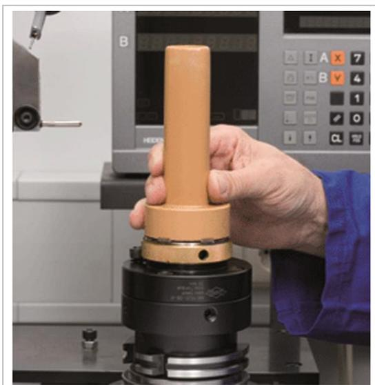
Abb. 8: HSK-Schnittstelle reinigen
