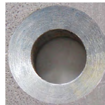
Escareador cônico com passo extremamente diferenciado
