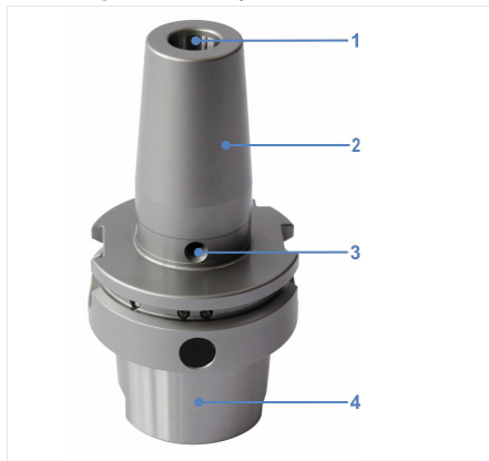
Abb. 1: Einzelne Komponenten des Schrumpffutters
