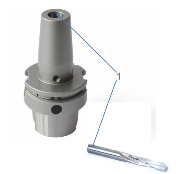
Abb. 5: Schrumpffutter und Werkzeug reinigen
