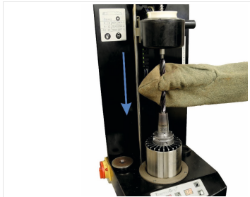
Abb. 8: Werkzeug in Aufnahmebohrung einführen
