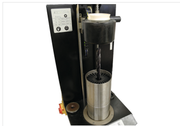
Abb. 9: Schrumpffutter mit Werkzeug abkühlen
