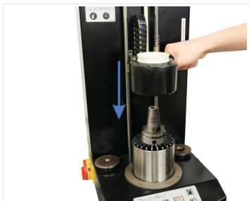
Abb. 7: Schrumpffutter mit Schrumpfgerät erwärmen
