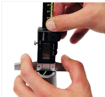
Abb. 6: Schrumpffutter auf Werkzeuglänge einstellen
