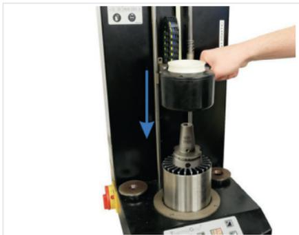
Abb. 7: Schrumpffutter mit Schrumpfgerät erwärmen
