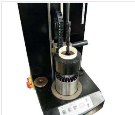
Abb. 10: Schrumpffutter mit Werkzeug erwärmen
