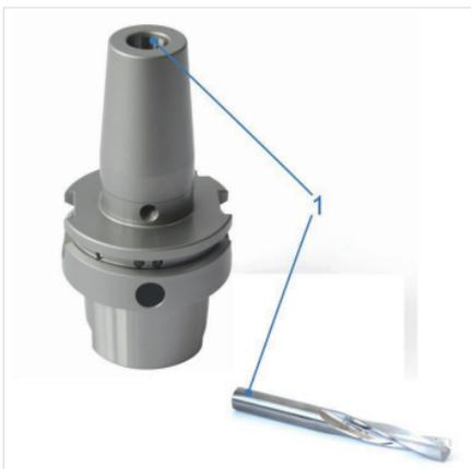
Abb. 5: Schrumpffutter und Werkzeug reinigen
