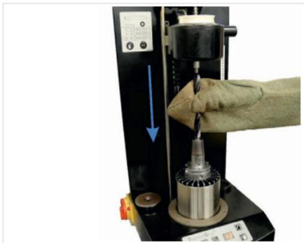
Abb. 8: Werkzeug in Aufnahmebohrung einführen
