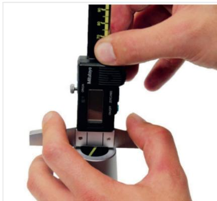
Abb. 6: Schrumpffutter auf Werkzeuglänge einstellen
