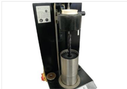
Abb. 9: Schrumpffutter mit Werkzeug abkühlen
