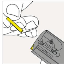
3. Die Wendeplatte herausnehmen. Die Wendeplatte und den Wendeplattensitz reinigen (keine Druckluft verwenden, Justierkeile beachten). Die Wendeplatte wenden bzw. neue Wendeplatte einsetzen.
