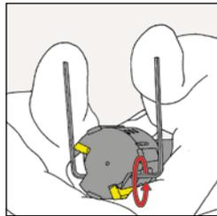
2. **Hinweis:** Zum Öffnen müssen zwei Schlüssel verwendet werden. Zum Lösen der Spannplatte die TORX®-Schraube bzw. die Gewindespindel von oben nach links und von unten nach rechts drehen.
