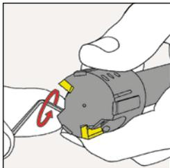
5. Zur Grobeinstellung den vorderen und hinteren Gewindestift eine viertel Umdrehung nach rechts drehen.
