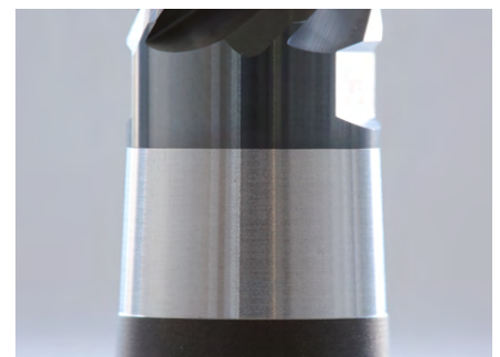
3. Den Wechselfräskopf im Uhrzeigersinn handfest in den Wechselkopfhalter eindrehen. Anschließend den Wechselkopfhalter samt Werkzeug in den Maschinenhalter einspannen.
