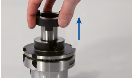
1. Den Mitnehmerring vom Aufsteckfräserdorn nehmen.
