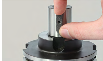
2. Die Passfeder am Aufsteckfräserdorn einsetzen.
