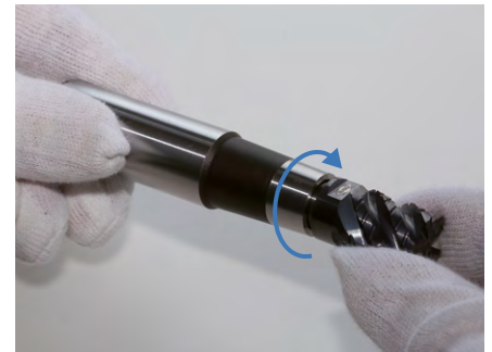
3. Den Wechselfräskopf im Uhrzeigersinn handfest in den Wechselkopfhalter eindrehen. Anschließend den Wechselkopfhalter samt Werkzeug in den Maschinenhalter einspannen.
