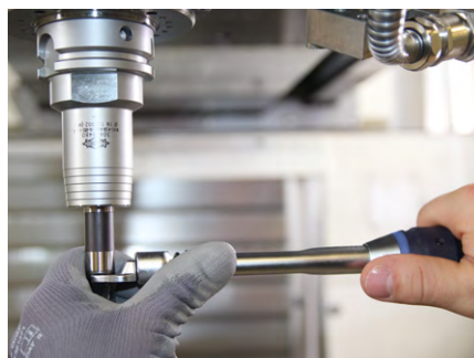
5. Hinweis: Die freie Hand an den Wechselfräskopf legen, um eine feinfühilige Abstimmung durchführen zu können. Dadurch kann das Anzugsdrehmoment genauer eingestellt werden.
