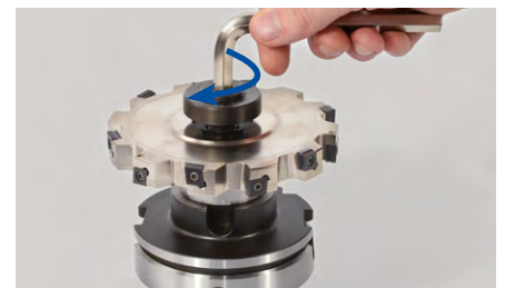
8. Die Fräseranzugsschraube mit Hilfe eines Innensechskantschlüssels weiter im Uhrzeigersinn eindrehen und anschließend mit einem Drehmomentschlüssel anziehen (Anzugsdrehmoment siehe Tabelle „Anzugsdrehmoment für Fräseranzugsschraube“).
