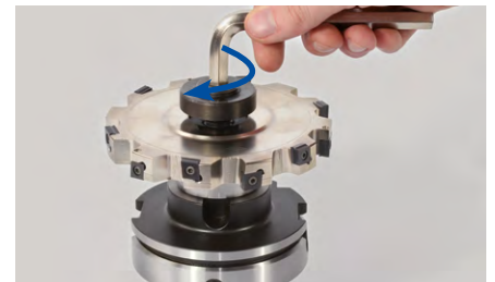
8. Seguir enroscando el tornillo de apriete de la fresa con una llave Allen en el sentido de las agujas del reloj y, a continuación, apretar con una llave dinamométrica (para el par de apriete, véase la tabla «Par de apriete para el tornillo de apriete de la fresa»).
