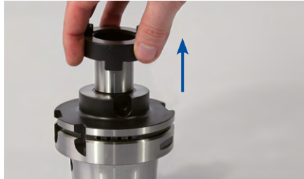
1. Extraer el anillo arrastrador del portafresa.
