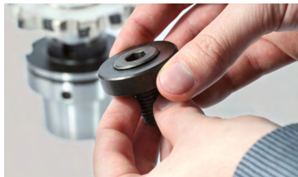
6. Girar el perno roscado hasta que se produzca un saliente de 1-2 mm respecto al anillo roscado.
