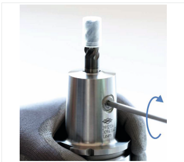
Abb. 5: Spannschraube mit Anzugsdrehmoment anziehen
