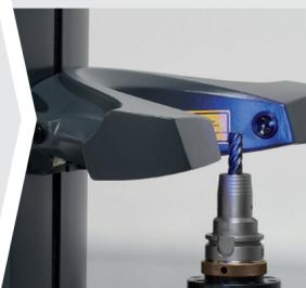
Dispositivos de ajuste e medição leve convencem com precisão e facilidade de utilização no ajuste das ferramentas.
