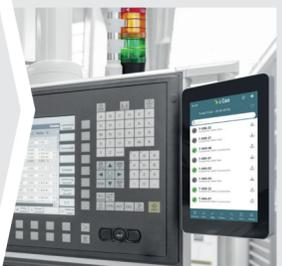
Digitalização rápida e fácil: A e-Connect Box transmite digitalmente os dados de medição do dispositivo de ajuste para a máquina-ferramenta. Além disso, monitoriza o estado da máquina, entre outras coisas.
