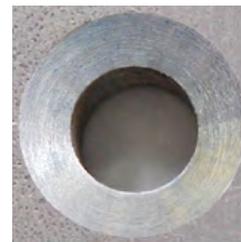
Avellanador cónico dividido de forma extremadamente irregular
