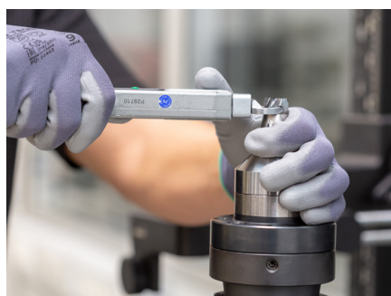
5. Den Wechselfräskopf mit Hilfe des Drehmomentschlüssels, dem passenden Mauleinsteckschlüssels und dem angegebenen Anzugsdrehmoment anziehen (siehe Tabelle „Anzugsdrehmomente der Wechselfräsköpfe“).
