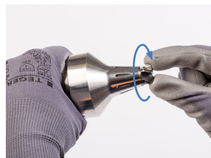
3. Den Wechselfräskopf im Uhrzeigersinn handfest in den Wechselkopfhalter eindrehen. Anschließend den Wechselkopfhalter samt Werkzeug in ein Einstellgerät oder ein Montagesystem einspannen.
