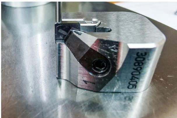
Bei der einfachen und schnellen Schneideneinstellung der Außenreibahle mit EasyAdjust-System dient die flache Unterseite der Kasette als Referenzfläche. Dort ist auch das entsprechende Einstellmaß zu finden. ©Klaus Vollrath
