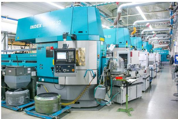
In der Maschinenhalle stehen Mehrspindel-Drehautomaten dicht an dicht. ©Klaus Vollrath
