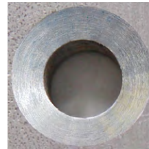
Avellanador cónico dividido de forma extremadamente irregular
