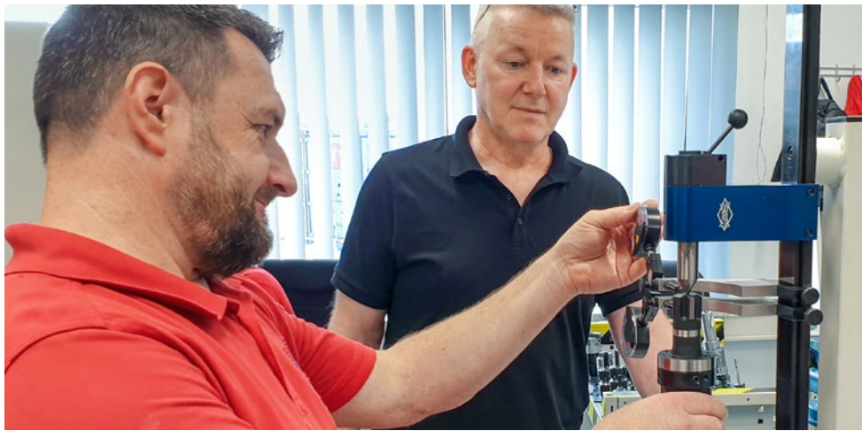
Maik Wagenlehner, Mitarbeiter Werkzeugvoreinstellung bei der Continental Aerospace Technologies GmbH (links), und Tim Helgert, technischer Berater bei MAPAL, beim Einstellen des MAPAL Werkzeug mit HX-Wendeschneidplatten.
