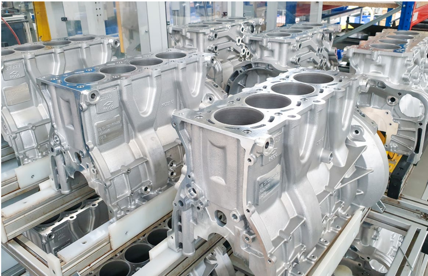
Jedes Kilogramm weniger hilft weiter: Zur Gewichtseinsparung hat die Continental Aerospace Technologies GmbH für die Kurbelgehäuse das im ursprünglichen PKW-Motor eingesetzte Gussmaterial durch Aluminium ersetzt.
