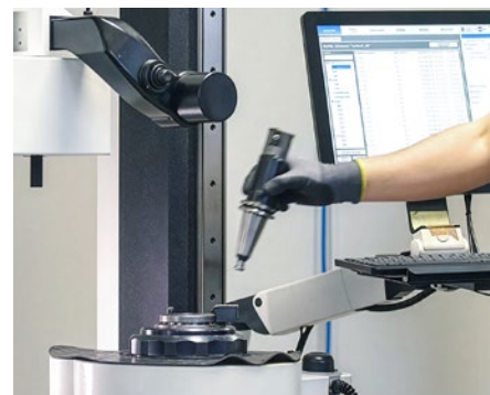
Das Werkzeugausgabesystem UNIBASE-M sowie zwei UNISET Einstellgeräte von MAPAL sichern die stetige Verfügbarkeit aller benötigten Werkzeuge für die gesamte Produktion. ©Casappa S.p.A.
