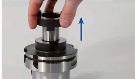
1. Démontez la bague d'entraînement de l'arbre porte-fraise.
