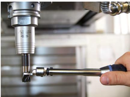
4. Placer la clé dynamométrique aussi horizontalement que possible sur la tête de fraisage amovible et ne pas l'incliner avec le plan de la clé.
