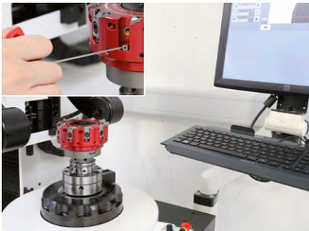
**7. Réglage avec le poste de réglage (optique)**
