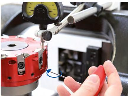
**10. Déterminer de manière optique ou tactile l'insert de fraisage avec l'arête de coupe la plus haute et remettre le micromètre à zéro. Régler au moyen du micromètre tous les inserts de fraisage par rapport à l'arête de coupe la plus haute. Dans ce contexte, tourner la vis de réglage avec une clé Allen dans le sens horaire jusqu'à atteindre la cote zéro (tolérance ± 2 µm).**
