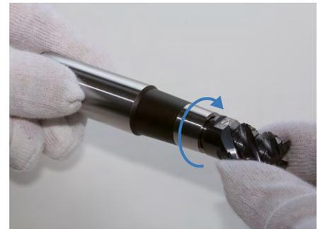
3. Serrer à la main dans le sens horaire la fraise à têtes interchangeables dans son porte-outil. Fixer ensuite le support de tête amovible avec l'outil dans le support de la machine.
