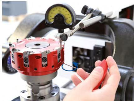
**8. Réglage avec le micromètre (comparateur)**
