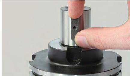
2. Monter la clavette sur l'arbre porte-fraise.
