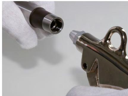
2. Utiliser de l'air comprimé et un chiffon pour nettoyer le support de tête amovible au niveau du cône, du filet et de l'appui plan.
