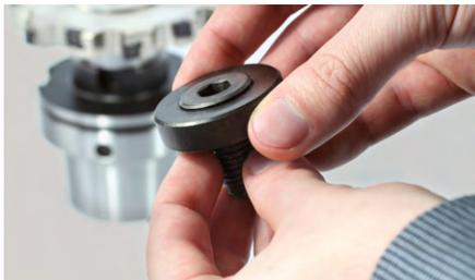
6. Tourner le boulon fileté jusqu'à ce qu'il soit en saillie de 1 à 2 mm par rapport à la bague fileté.
