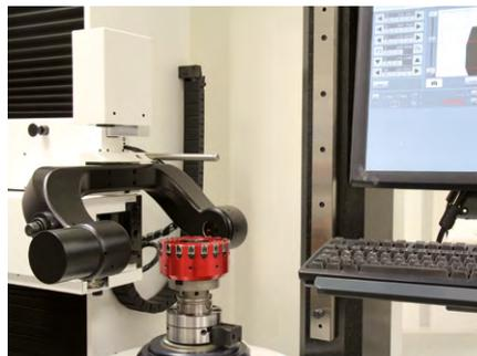
5. Avec le poste de réglage optique, régler un insert de fraisage à  $-0,01$  mm devant la cote (EM). À ce sujet, saisir avec le dispositif de mesure optique l'arête de coupe et tourner la broche filetée avec une clé Allen dans le sens horaire jusqu'à obtenir  $EM = -0,01$  mm. Pour un réglage purement optique, renouveler cette procédure pour tous les autres inserts de fraisage (ensuite poursuivre avec l'étape 7).
