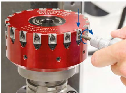
4. Pendant le serrage, appuyer légèrement sur l'insert de fraisage de telle manière que le vé de réglage soit contre.
