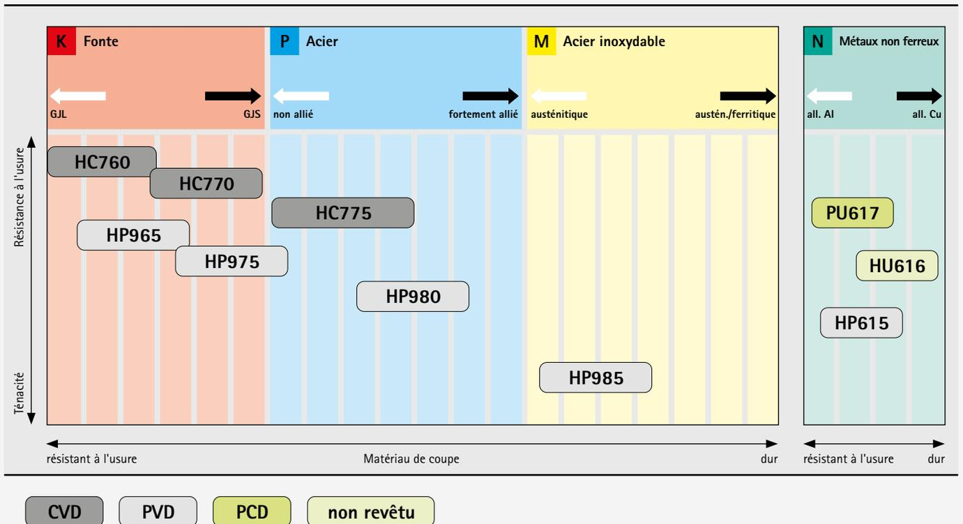
Aperçu des matériaux de coupe | Fraises de grande avancée et à copier de la fabrication de moules et de matrices
