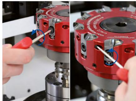
1. Desserrer l'insert de fraisage et le démonter.
