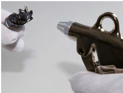
1. Den Wechselfräskopf an Kegel, Gewinde und Planfläche mit Druckluft und Tuch reinigen.
