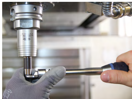
5. Hinweis: Die freie Hand an den Wechselfräskopf legen, um eine feinfühlige Abstimmung durchführen zu können. Dadurch kann das Anzugsdrehmoment genauer eingestellt werden.
