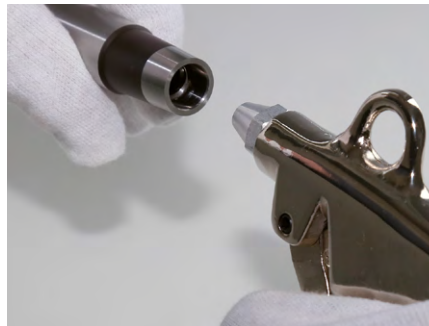
2. Den Wechselkopfhalter an Kegel, Gewinde und Planfläche mit Druckluft und Tuch reinigen.
