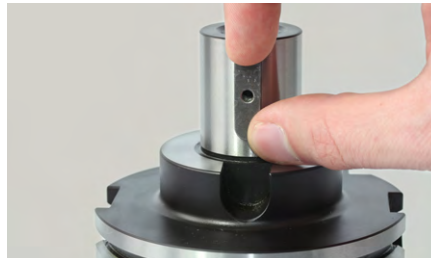
2. Die Passfeder am Aufsteckfräserdorn einsetzen.
