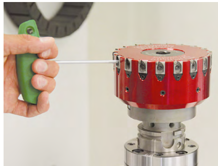
2. Die Spannschraube des Fräseinsatzes lösen und nach oben aus der Schwalbenschwanzführung entnehmen.
