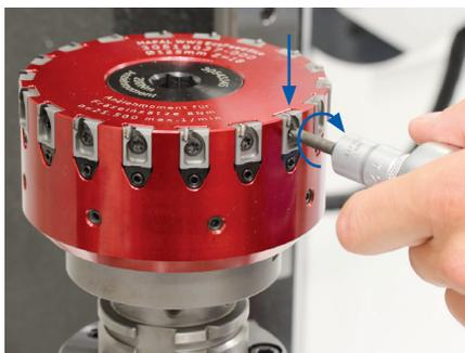
4. Den Fräseinsatz während des Anziehens leicht andrücken, sodass der Justierkeil anliegt. Die Spannschraube\*\* des Fräseinsatzes einsetzen und mit 1-2 Nm im Uhrzeigersinn anziehen.
