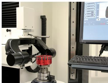
5. Mit dem Einstellgerät optisch einen Fräseinsatz  $-0,01\text{ mm}$  vor Einstellmaß (EM) einstellen. Hierzu mit der optischen Messeinrichtung die Schneidkante erfassen und die Gewindespindel mit einem Innensechskantschlüssel im Uhrzeigersinn drehen bis  $\text{EM} = -0,01\text{ mm}$  erreicht ist. Für eine rein optische Einstellung dieses Vorgehen für die restlichen Fräseinsätze wiederholen (anschließend weiter mit Schritt 7).
