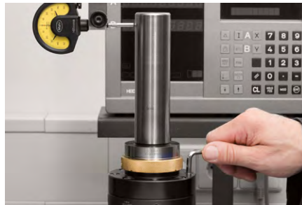
5. Zur Winkelausrichtung die Messuhr an der oberen Kontrollstelle beziehungsweise ca. 100 mm von der Trennstelle entfernt positionieren. Winkelausrichtung mittels der Ausrichtschrauben vornehmen. Die Ausrichtschrauben nach der Betätigung nicht entspannen.
