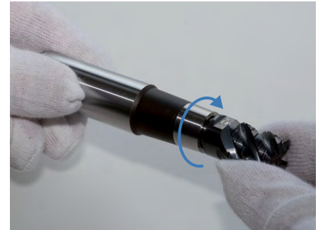
3. 交換ミーリングヘッドを時計回りにしっかり交換ヘッドホルダーにねじ込みます。次に交換ヘッドホルダーをツールと一緒にマシンホルダーに固定します。
