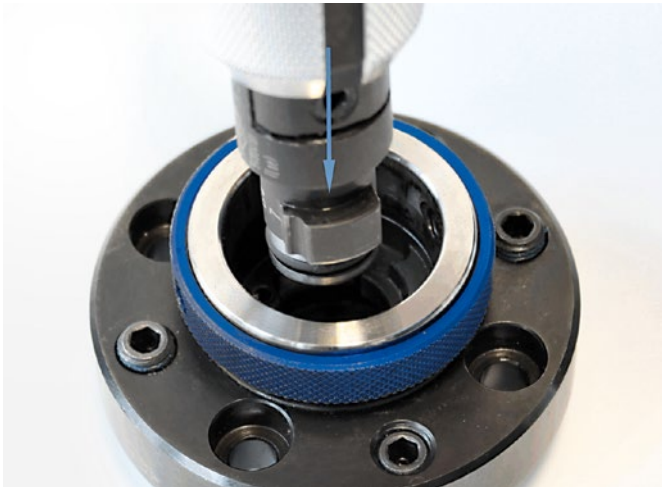
Einsetzen der KS-Spannpatrone
