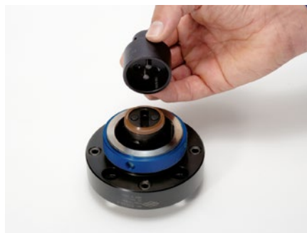
2. Steckschlüssel an der Spannpatrone ansetzen.
