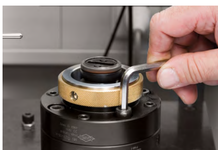
2. Vorsatzflansch einfügen. Befestigungsschrauben anlegen.
