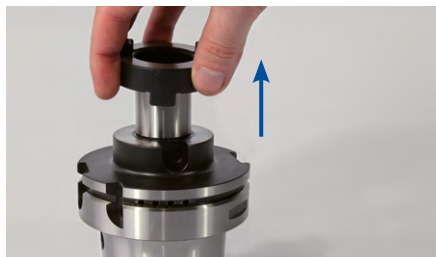
1. Zdjąć pierścień prowadzący z trzpienia frezarskiego nasadzanego.
