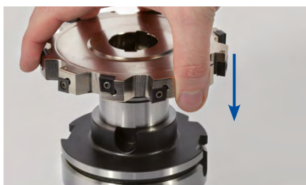
5. Umieścić narzędzie czołowo na trzpieniu frezarskim nasadzonym.
