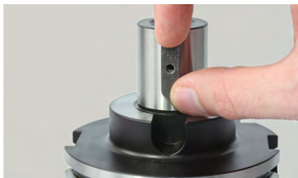
2. Włożyć wpust piórowy na trzpień frezarski nasadzany.
