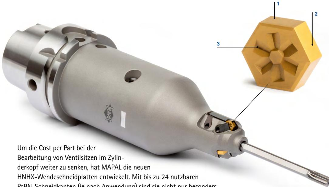
Um die Cost per Part bei der Bearbeitung von Ventilsitzen im Zylinderkopf weiter zu senken, hat MAPAL die neuen HNHX-Wendescheidplatten entwickelt. Mit bis zu 24 nutzbaren PcBN-Schneidkanten (je nach Anwendung) sind sie nicht nur besonders wirtschaftlich, sondern nutzen auch den Schneidstoff bestmöglich aus. Dank der hohen Qualität der Schneidkanten werden mit den neuen HNHX-Wendescheidplatten Oberflächengüten von  $< R_a 0,2 \mu\text{m}$  erreicht.
