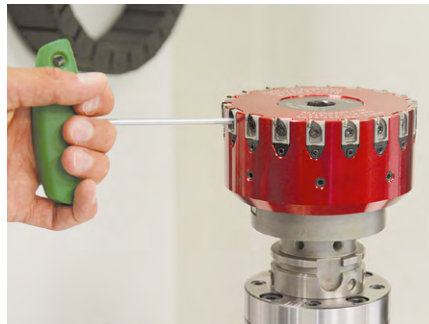
2. Allentare la vite di serraggio della cartuccia di fresatura e sfilarla verso l'alto dalla guida a coda di rondine.
