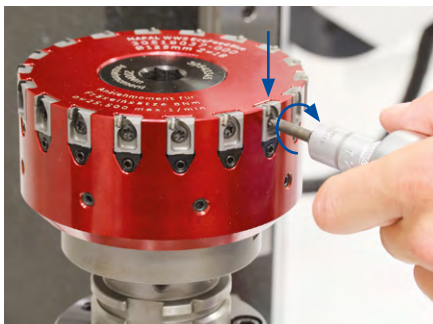
4. Premere leggermente la cartuccia di fresatura durante il serraggio, in modo che il cuneo di regolazione aderisca correttamente. Inserire la vite di serraggio** della cartuccia di fresatura e avvitare in senso orario con 1-2 Nm.
