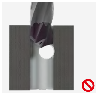
Perçage excentré ; Arête transversale pas en prise
