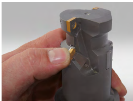
3. Appuyer la cassette et le v \acute{e} de r \acute{e} glage vers l'avant, en direction de l'outil.
