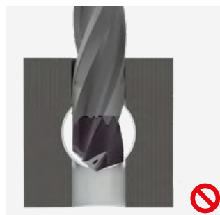
Perçage centré et \gg D
