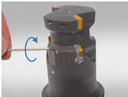
1. Desserrer le v \acute{e} de r \acute{e} glage avec une cl \acute{e} Allen et tourner d'un demi-tour dans le sens antihoraire.
