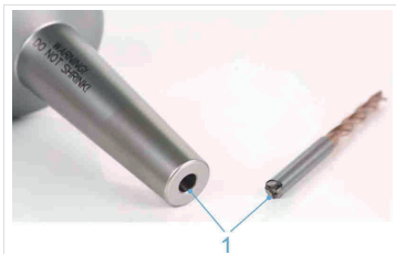
Abb. 8: Dehnspanfutter und Werkzeug reinigen
