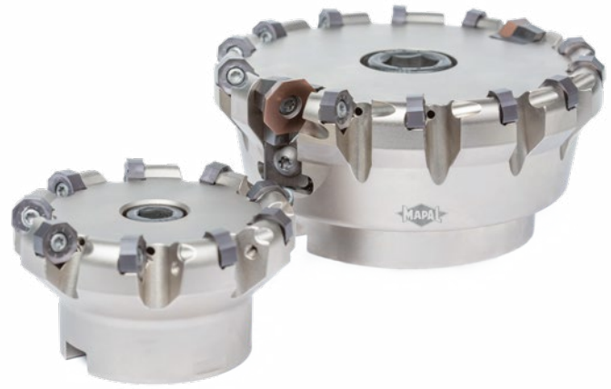
Einzigartig und absolut prozesssicher: der NeoMill-16-Finish (rechts) mit der Kombination aus 16-schneidiger Vorbearbeitungsschneide (ONMU05) und achtschneidiger Wendeschneidplatte zum Schlichten von Stahl- und Gusswerkstoffen. Der NeoMill-16-Face (links) steht für eine effiziente Vorbearbeitung beim Planfräsen.
