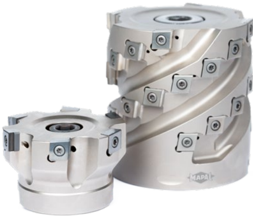
Die neuen einreihigen Eckfräser und mehrschneidigen Walzenstirnfräser der NeoMill-Alu Rough Baureihe stehen für eine stabile Schruppbearbeitung von Aluminiumgussbauteilen auch bei hohen Zeitspannvolumina.
