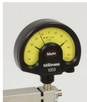
測定圧を減らしたミクロン精度のダイヤルゲージ (1/1000 mm)
