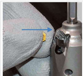
Abb. 8: Neue Wendeschneidplatte einsetzen
