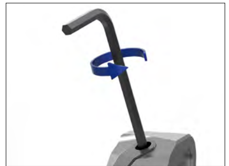
3. Gewindespindel 1,5 Umdrehungen gegen den Uhrzeigersinn drehen.
