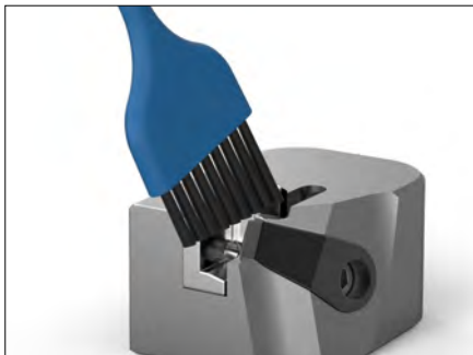
4. TEC-Wendeplatte entnehmen. Wendeplattensitz und TEC-Wendeplatte säubern.
