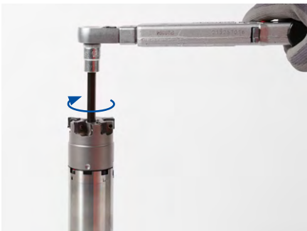
5. 将扭矩扳手设置到铣刀制造商所要求的拧紧扭矩。 6. 使用扭矩扳手将铣刀紧固螺栓拧紧到止挡位置。
