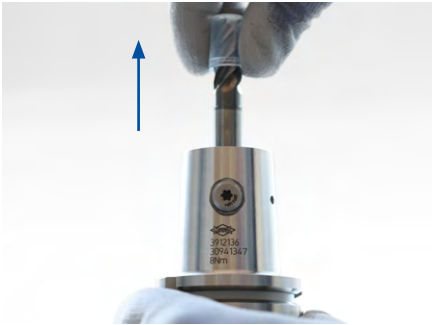
2. 从侧固式刀柄的装夹孔中取出刀具。
