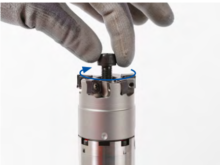
4. 用手将铣刀紧固螺栓轻轻地拧入套式铣刀刀柄的螺纹孔中。
